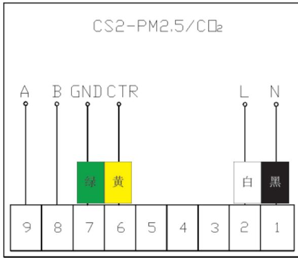
(按如图所示颜色接线，设备接线与之一一对应)
